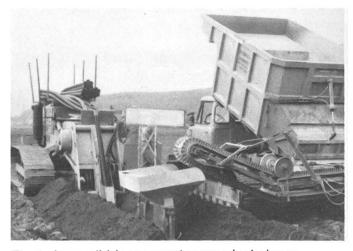
Fig. 1: Appareil à laser pour travaux de drainage.
