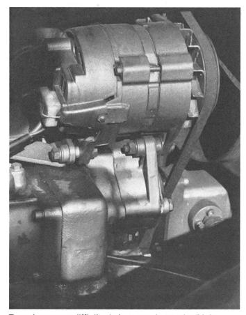
Remplacement difficile de la courroie trapézoïdale.
