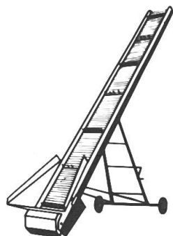
Élévateur-transporteur polyvalent chaîne à barettes pour silos allant jusqu'à 5 m)
