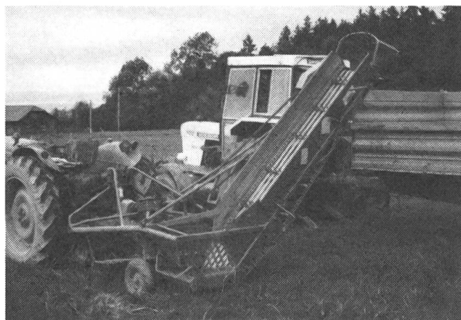
Fig. 2: L'arracheuse-chargeuse Thyregod est une machine peu compliquée. Elle soulève 2 rangs de betteraves décollées préalablement et les transfère sur un crible en étoiles. De là, elles passent sur un transporteur incliné qui charge un véhicule de transport remorqué parallèlement.
