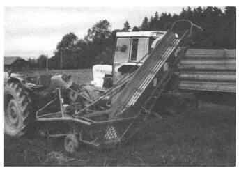
Fig. 2: L'arracheuse-chargeuse Thyregod est une machine peu compliquée. Elle soulève 2 rangs de betteraves décolletées préalablement et les transfère sur un crible en étoiles. De là, elles passent sur un transporteur incliné qui charge un véhicule de transport remorqué parallèlement.
