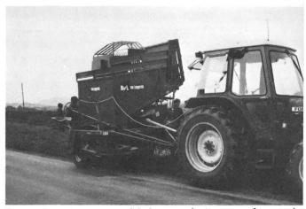
Fig. 5: Arracheuse combinée pour betteraves fourragères BvL van Lengerich à trémie à fond mouvant.
