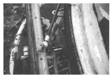
Fig. 4: Vue de détail du dispositif décolleteur de la machine Kemper. Il consiste en un disque coupeur dentelé et un couteau fixe.
