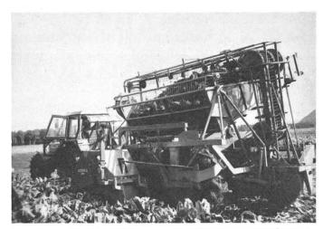
Fig. 3: La Stoll V 2000, une décolleteuse-arracheuse-débardeuse à 6 rangs.
