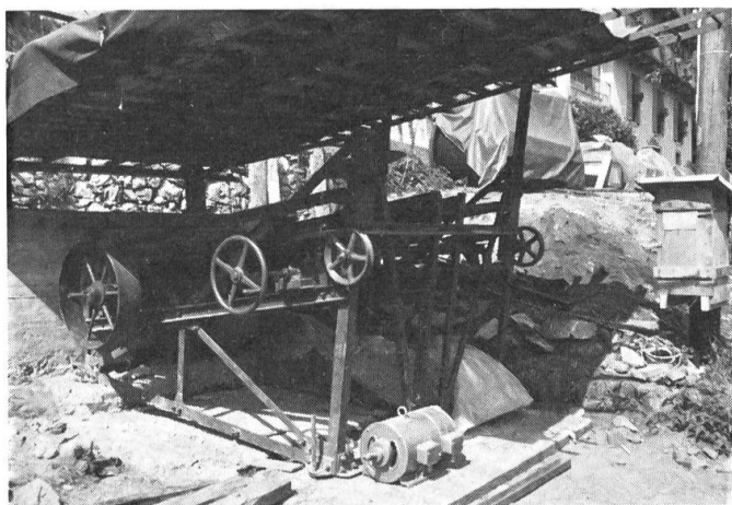
Fig. 1: Cette station se trouve à Loco, dans la vallée de l'Onsernone TI. Elle a dû être modifiée en installation électrique afin d'éviter des immissions de bruit.
