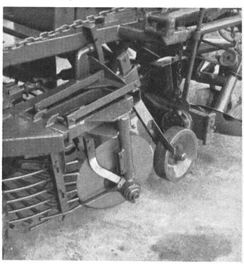
Détails du nouveau groupe arracheur à soc à disque rotatif: Ce dispositif permet de récolter malgré des conditions de travail normalement jugées impossibles.
