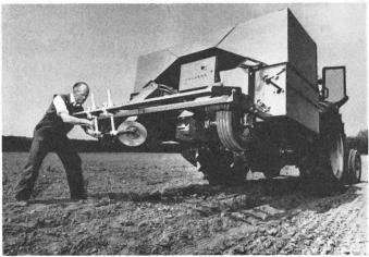
lage trois points et est actionnée par le système hydraulique du tracteur, celui-ci doit avoir une puissance minimale de 47 kW (63 ch).
