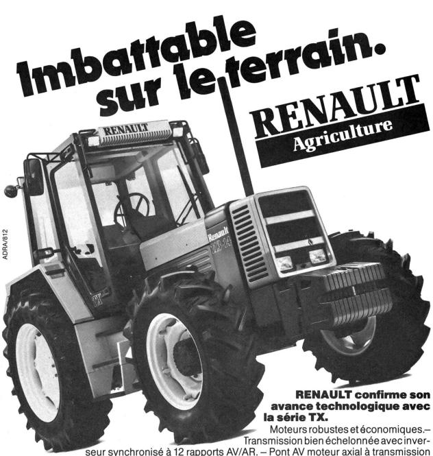
seur synchronisé à 12 rapports AV/AR. – Pont AV moteur axial à transmission directe intégrée, avec «Blocamatic». – Relevage hydraulique «Tracto-control» efficace et sensible. – Direction hydrostatique. – Freins à disques. – Cabine de sécurité basculable, insonorisée, avec chauffage et ventilation, visibilité panoramique. – Siège ergonomique. – **Options:** Relevage et prise de force AV, climatisation etc.
