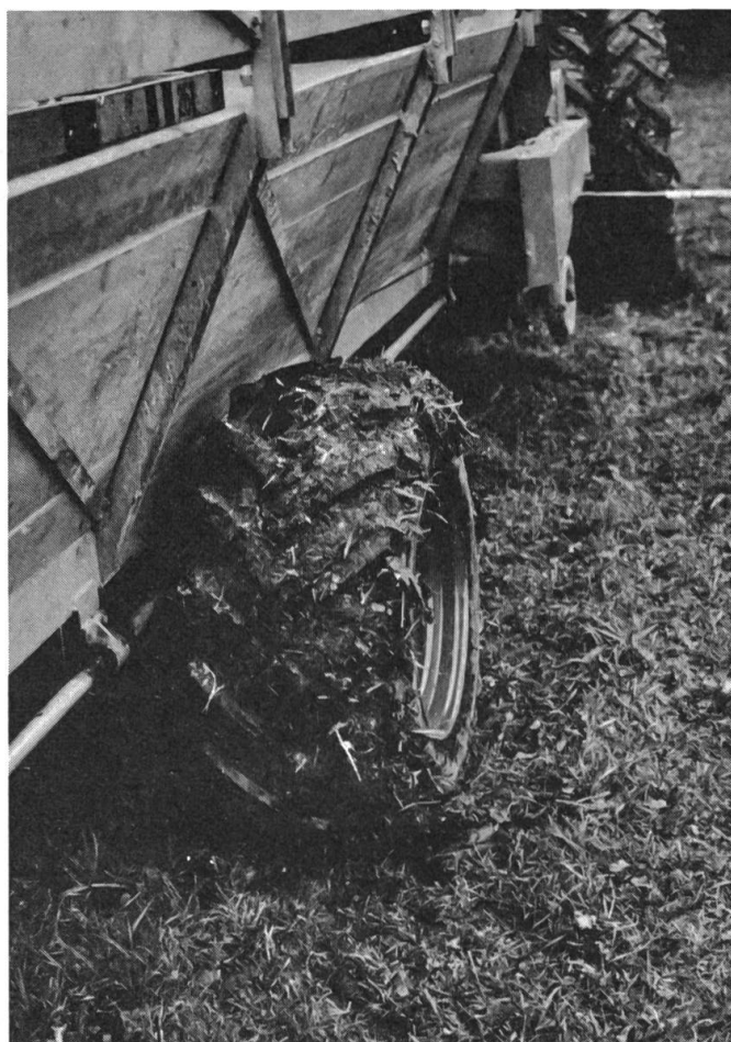
Fig. 8: Autochargeuse équipée de pneumatiques AS. Afin d'obtenir au freinage un effet autonettoyant de bonne qualité, les bandages sont montés avec profil dans le sens inverse de la marche.
