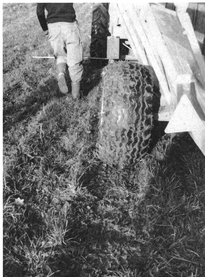
Fig. 5: Mesurage de la dérive. On détermine l'ampleur du glissement latéral des roues de la remorque par rapport à la voie du tracteur.
