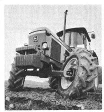
Le pont avant mécanique à roues inclinables équipe huit tracteurs John Deere de 60 à 132 ch DIN.
