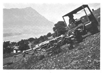
Fig. 2: Où la faneuse à toupies est mise en œuvre par char automoteur, l'appareil chargeur demande à pouvoir être changé rapidement et facilement, ce changement s'imposant en effet quotidiennement durant la fenaison.
