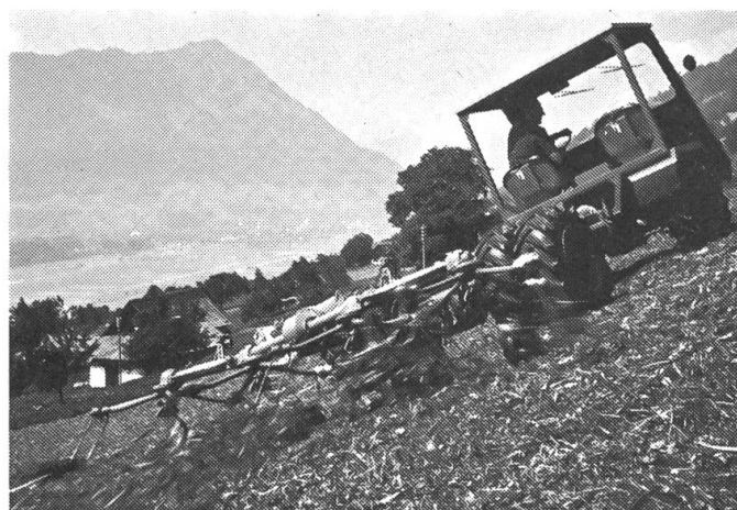
Fig. 2: Où la faneuse à toupies est mise en œuvre par char automoteur, l'appareil chargeur demande à pouvoir être changé rapidement et facilement, ce changement s'imposant en effet quotidiennement durant la fenaïson.
