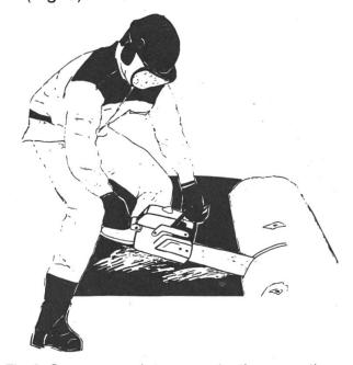
Fig. 3: Casque complet avec protection acoustique et faciale.
