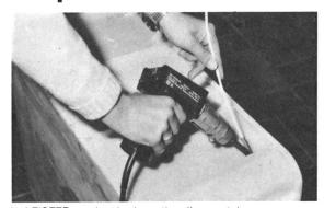
Le LEISTER pendant la réparation d'un container en polyaethylen.
