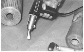
Le LEISTER pendant la soudure de feuilles PVC et Polyaethylen.
