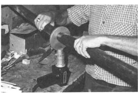
Le LEISTER pendant la soudure au miroir d'un tube en polyaethylen
