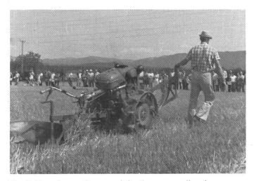
Fig. 3: Pour les petites exploitations ou celles à revenus d'appoint, le tracteur monoaxe à charrue portée avait une importance assez considérable au début de la mécanisation. Démonstration de son opération par un seul homme.
