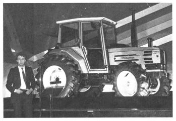
Fig. 3: Monsieur Max Hürlimann présente le modèle 466 sur la scène de la salle de démonstration. Moteur de 65 CV (48 kW), boîte de vitesses standard 24 x 12, 4 vitesses, engrenage à demi-vitesse et renversement synchronisés. Une version de transport de ce même modèle est également livrable.
