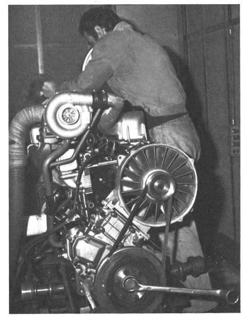
Fig. 2: Un nombre inusité de bancs d'essai individuels permet de roder chaque moteur assez longtemps. En ce moment, des modèles refroidis à air sont en cours de montage.
