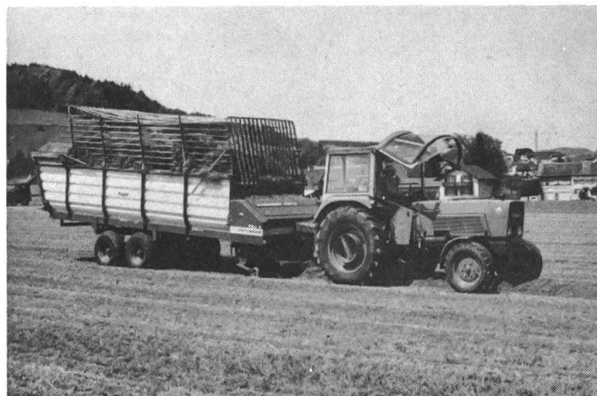
Fig. 2: Autochargeuse à coupe courte, 25 couteaux, 23 m 3 , tracteur: 40 kW (55 ch) suffit.
