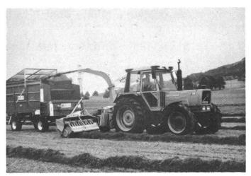
Fig. 1: Ramasseuse-hacheuse. tracteur nécessaire 66 kW (90 ch), char aut. 10 m<sup>3</sup>.
