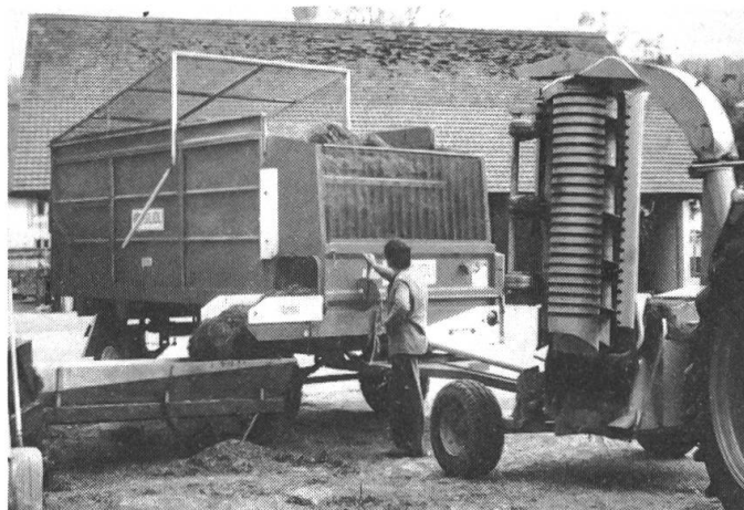
Fig. 3: Déchargement élégant par char aut. et convoyeur vertical, débit de déchargement: 18 t/h, dosage très régulier.
