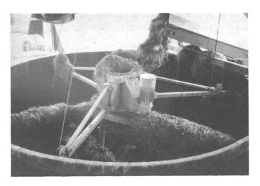
Fig. 5: Pour des silos de grands diamètres, la répartition régulière du fourrage est trés important, particulièrement si le désilage se fait mécaniquement. Hauteur fonctionnelle de ce répartiteur: 1,5 m.
