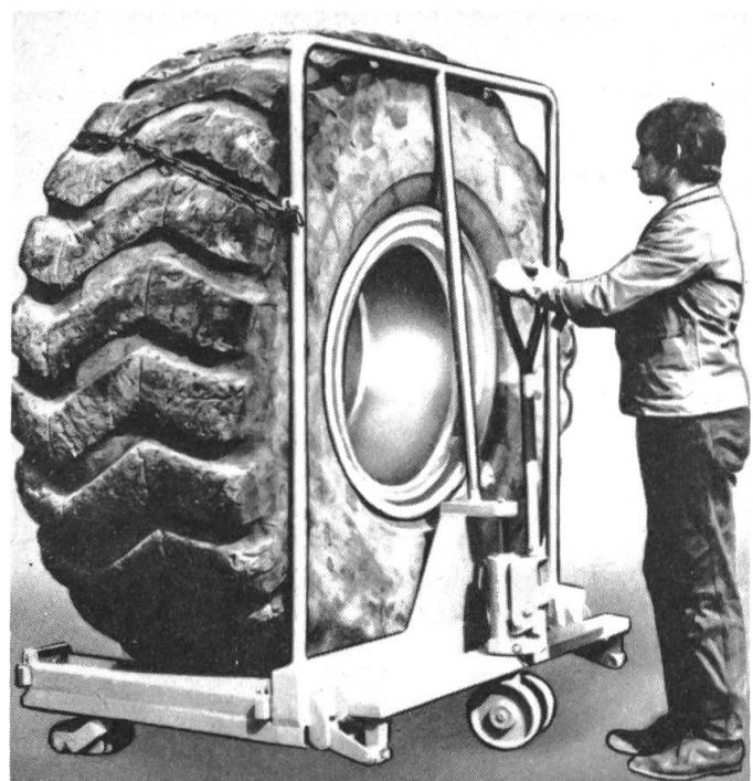
Nouveau chariot élévateur pour échange rapide et aisément de roues de tracteurs, poids lourds et machines de chantier.
