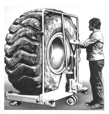
Nouveau chariot élévateur pour échange rapide et aisé de roues de tracteurs, poids lourds et machines de chantier.
