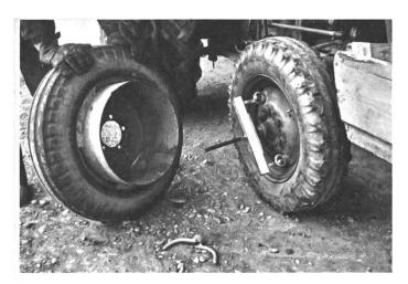
Fig. 1: La monte en pneumatiques jumelés pour roues avant construite avec de propres moyens.
