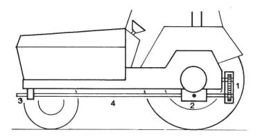
Fig. 0: Montage d'une prise de force à l'avant
