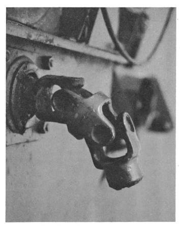
Fig. 1: Joint à double cardan.
