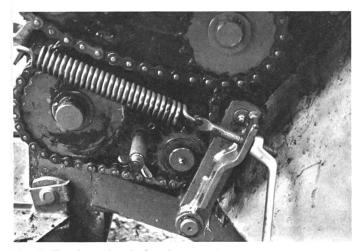
Fig. 3: Tendeur de chaîne à ressort.
