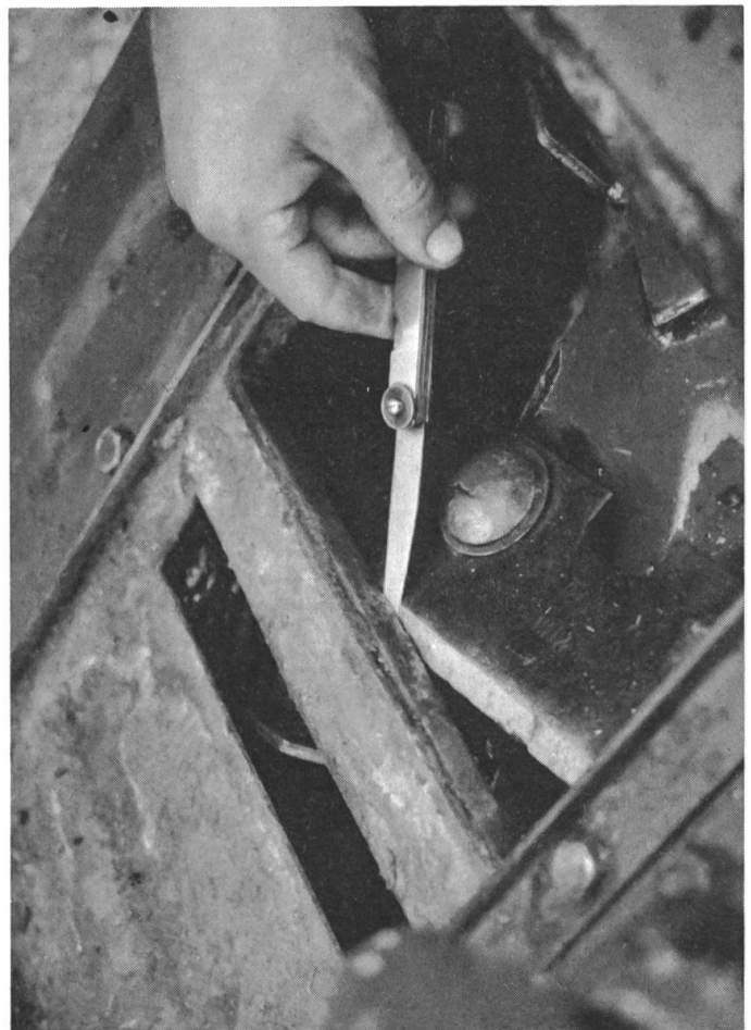
Fig. 9: Contrôler le jeu de coupe.
