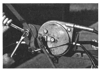
Fig. 11: Régler la commande Bowden.
