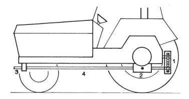
Fig. 0: Montage d'une prise de force à l'avant
