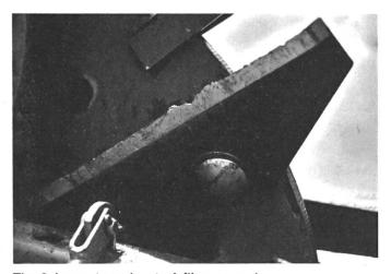
Fig. 8: Lame tranchante à fil prononcé.
