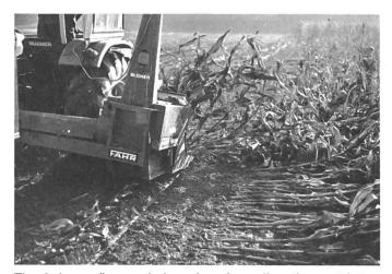
Fig. 3: Le maïs versé dans la même direction est introduit sans difficulte dans les rouleaux d'alimentation. Il n'en est pas de même s'il est versé dans différentes directions.
