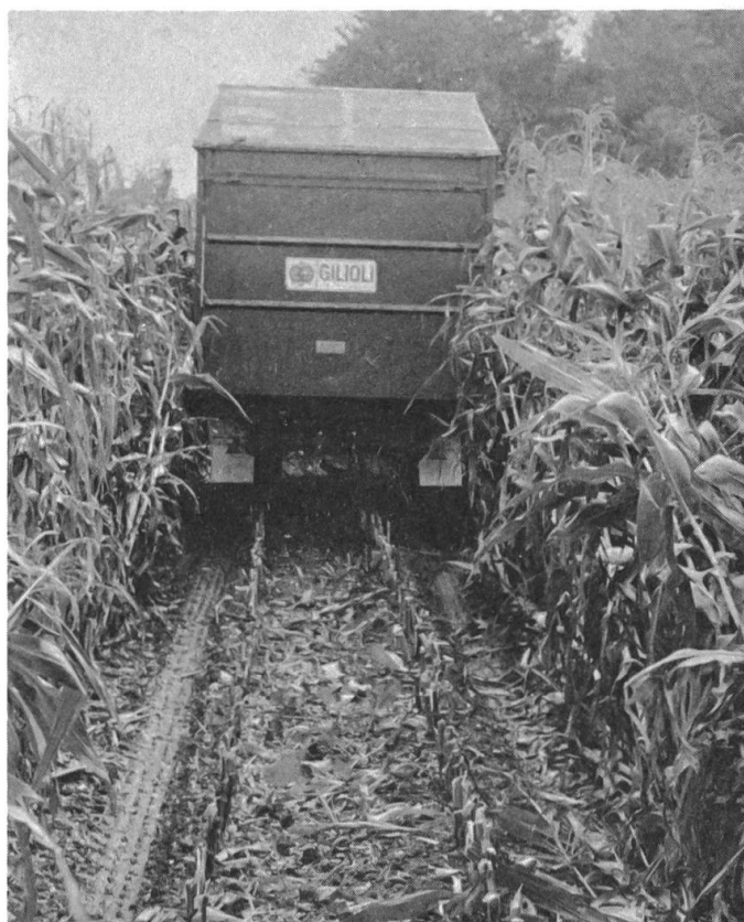
Fig. 2: Avec un modèle à deux rangs, fixé à l'avant, il est facile, en plaine de commencer la coupe par un passage à travers le champ.
