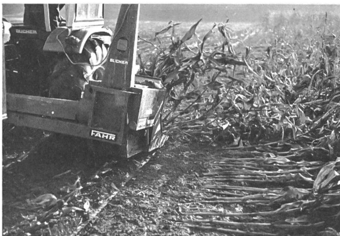
Fig. 3: Le maïs versé dans la même direction est introduit sans difficulté dans les rouleaux d'alimentation. Il n'en est pas de même s'il est versé dans différentes directions.
