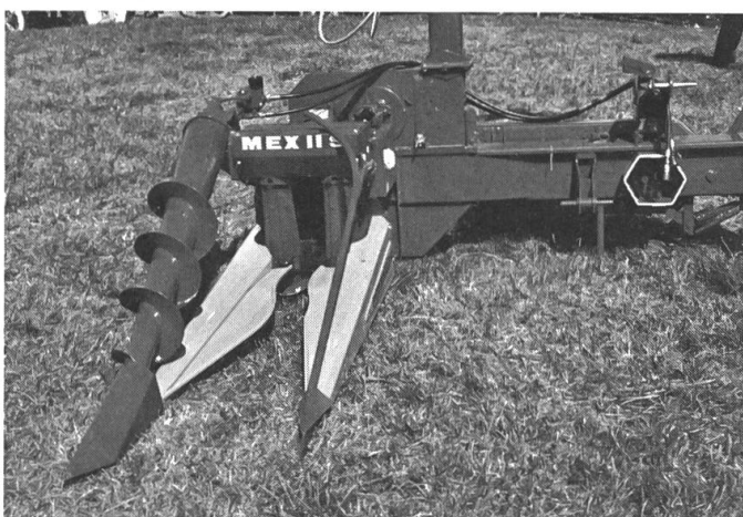
Fig. 4: L'adaptation d'une vis sans fin facilité le fauchage du maïs versé. Cependant, son prix d'achat de Fr. 1150.- est élevé.
