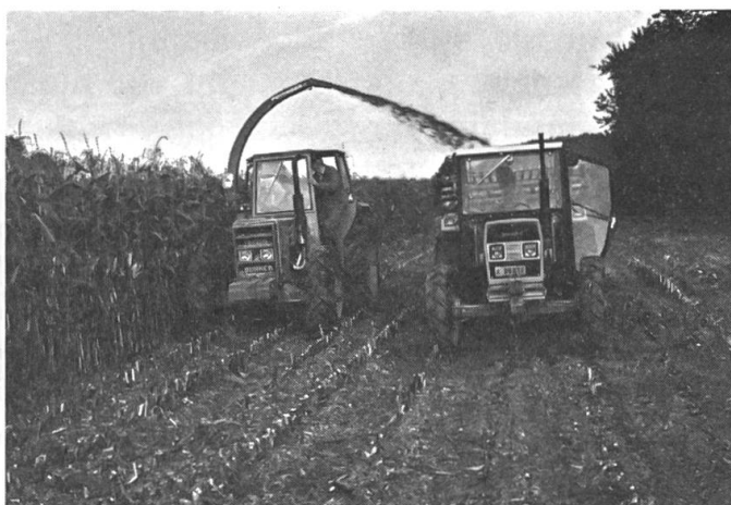
Fig. 1: Si on opère par traction parallèle, la hacheuse devrait être munie d'un coude de sortie pouvant être prolongé en hauteur et largeur.
