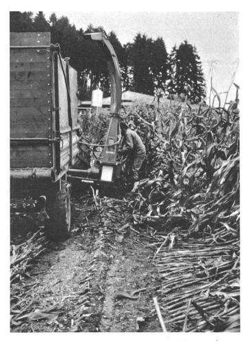
Fig. 5: En cas de bourrage, un dispositif de marche arrière est précieux.
