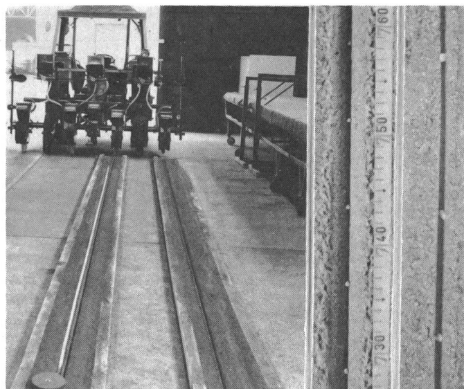
Fig. 1: L'examen de la précision du semis de betteraves, de maïs et de fèves s'est effectué sur une bande de sable de 20 m. A droite: Vue de détail de la dépose, à vitesse favorable, de semences de betteraves et de maïs.
