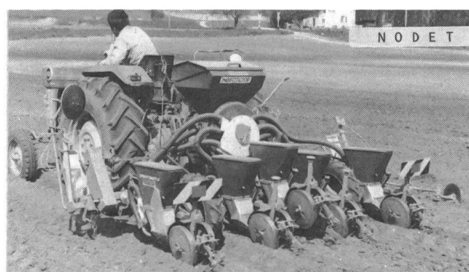
Fig. 5: Ensemencement de maïs en sol bourbeux; au moyen de semoirs monograinne pneumatiques. Par comparaison avec les autres solutions, les galets de recouvrement en une pièce, avec profil de caoutchouc souple (à gauche: Becker, Hassia), n'ont pas présenté d'avantages mesurables.
