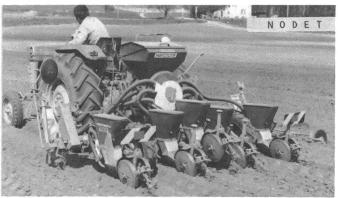
Fig. 5: Ensemencement de maïs en sol bourbeux, au moyen de semoirs monograine pneumatiques. Par comparaison avec les autres solutions, les galets de recouvrement en une pièce, avec profil de caoutchouc souple (à gauche: Becker, Hassia), n'ont pas présenté d'avantages mesurables.
