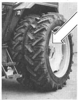
Grâce au système AW d'accouplement des roues jumelées GS. Que la roue montée sur votre tracteur soit large ou étroite, l'autre roue se fixe automatiquement et est immédiatement utilisable comme roue jumelée sans modifications désagréables. Notre principe est sans pareil sur le marché européen et des attestations internationales le prouvent.
