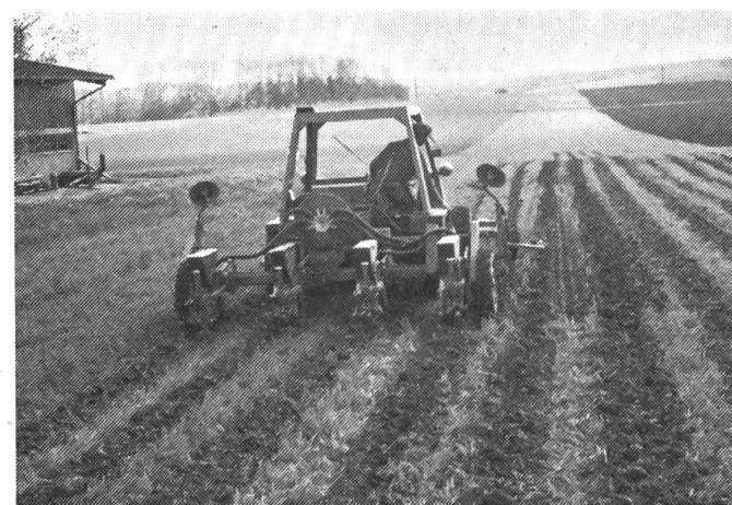
Fig. 3: Les grains de maïs peuvent être déposés directement dans les rangs évidés par la fraise rotative.
