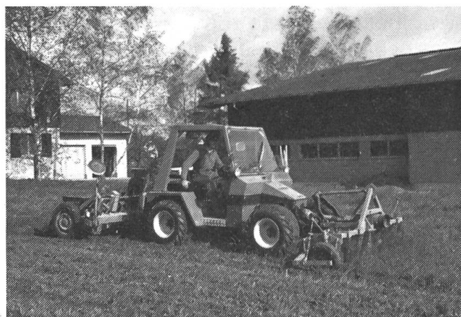
Fig. 1: Tracteur TM 1000 équipé d'une fraise à bandes et d'un semoir mongraine actionnés respectivement par des systèmes hydrauliques individuels avant et arrière.
