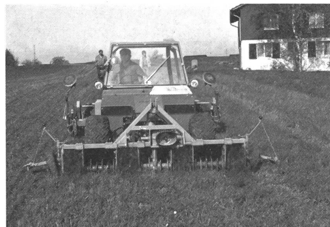
Fig. 2: Cette fraise transformée prépare un lit de semences d'une largeur approximative de 25 cm.
