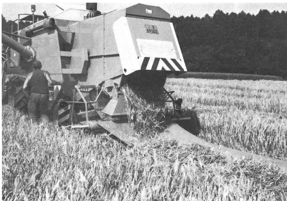
Fig. 1: Essais de mesurage pour moissonneuses-batteuses: La paille courte et la paille longue sortant de la machine sont recueillies séparément dans deux toiles distinctes et on mesure simultanément les temps de travail et la consommation de carburant.
