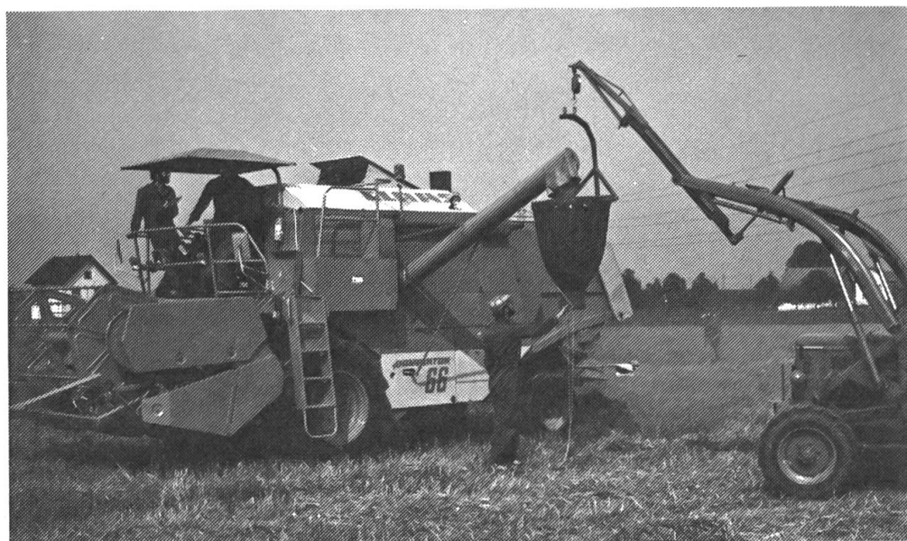
Fig. 3: Après chaque trajet de mesurage, il s'agit de déterminer également le poids du grain et de prélever des échantillons.
