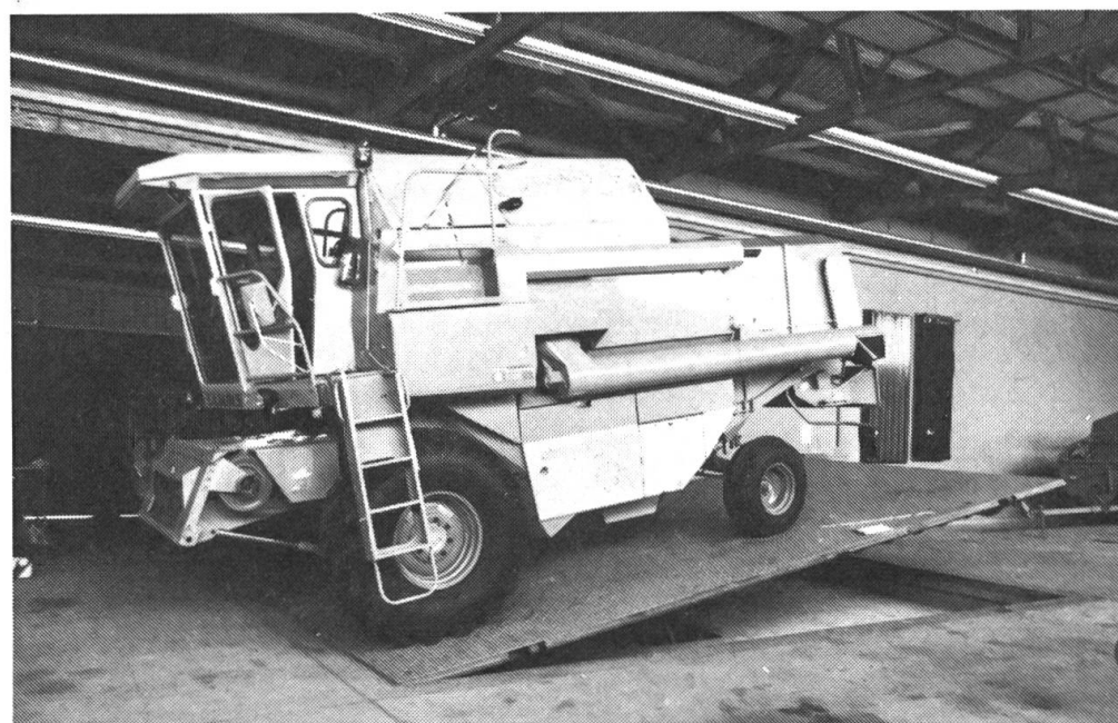
Fig. 4: Test de l'efficacité du frein à main sur une rampe basculante.
