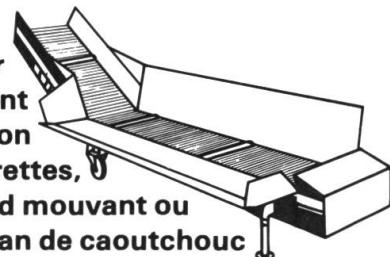
Convoyeur de déchargement et d'alimentation chaîne à barettes, fond mouvant ou ruban de caoutchouc
