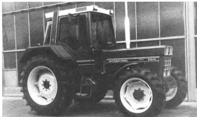
Dans l'objectif d'une recherche constante vers une plus grande efficacité, INTERNATIONAL HARVESTER présente deux nouveaux modèles de tracteurs: le IH 956 XL avec 70 kW/95 CV DIN et le IH 1056 XL avec 77 kW/105 CV DIN. Ces deux modèles prennent le relais du IH 955 XL et IH 1055 XL.
