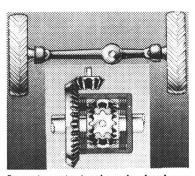
Le pont avant mécanique s'enclenche en cours de marche, et en pleine traction sur simple pression d'un commutateur.
