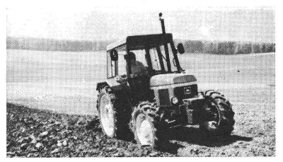
Les tracteurs John Deere 3-cylindres comportent de nombreuses caractéristiques proposées habituellement sur les tracteurs «haut de gamme». Cela signifié que les 940 de 44 ch DIN (32 kW), 1040 de 50 ch DIN (37 kW) et 1140 de 56 ch DIN (41 kW), peuvent effectuer une plus grande variété de travaux par rapport à la plupart de leurs con-
