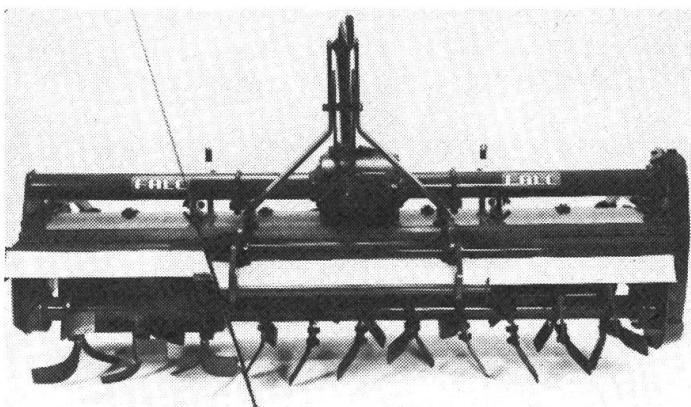
ainsi que d'une **grande tôle brise-mottes arrière** échancrée, réglable avec pression par ressorts.
