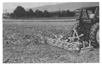
La nouvelle BELRECOLT HRB est une herse rotative très robuste. 5 modèles avec largeurs de travail de 1, 2 jusqu'à 3 mètres. Tous les modèles équipés d'un rouleau niveleur sans axe central, diamètre de 40 cm avec 8 tiges fixes et 8 tiges amovibles. Vitesses de prise de force 540 et 1000 min-1. Les avantages principaux:
