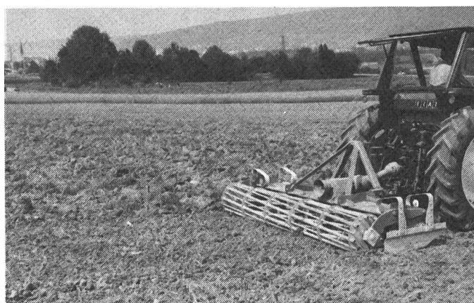
La nouvelle BELRECOLT HRB est une herse rotative très robuste. 5 modèles avec largeurs de travail de 1, 2 jusqu'à 3 mètres. Tous les modèles équipés d'un rouleau nivelleur sans axe central, diamètre de 40 cm avec 8 tiges fixes et 8 tiges amovibles. Vitesses de prise de force 540 et 1000 min-1.
