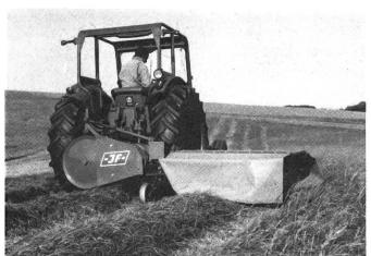
Fig. 1: Faucheuse rotative CM 167.
