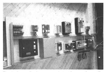
Fig. 1: Appareils de commande testés pour la ventilation du foin
