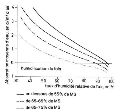
Fig. 2: Absorption moyenne d'eau, dépendant du taux d'humidité rel. de l'air et des différents degrés de séchage du foin.
