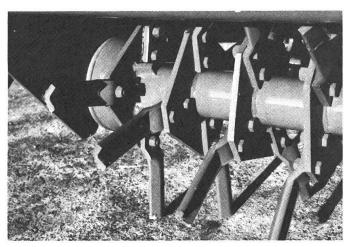
Fig. 2: *Rotor à dents* pour la fraise rotative KRONEvator (section agrandie)
