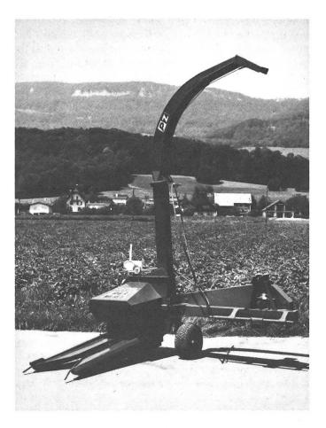
est mise sur le marché: la nouvelle MH-80 S développée par PZ-Zweegers (Hollande). Un prototype a déjà été testé l'année dernière avec d'autres modèles d'ensileuses tirées (cf. «Documentation de technique agricole», no 199, février 1982) et a eu d'exellents résultats, spécialement par le fait qu'elle nécessite un très faible besoin énergétique.
