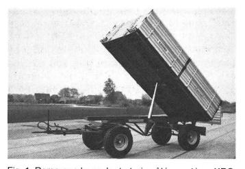
Fig. 1. Remorque basculante trois côtés système KRO-NE à hayons en aluminium eloxé. Faces extérieures profilées et faces intérieures lisses
