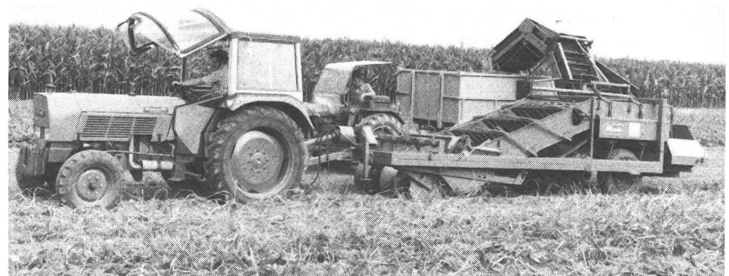
Fig. 8: Arracheuse-ramasseuse avec trois rubans cribleurs, trois rouleaux tire-fanes et bande de transfert (Hassia): à l'épierrage (en haut) et à l'arrachage de pommes de terre (en bas).
