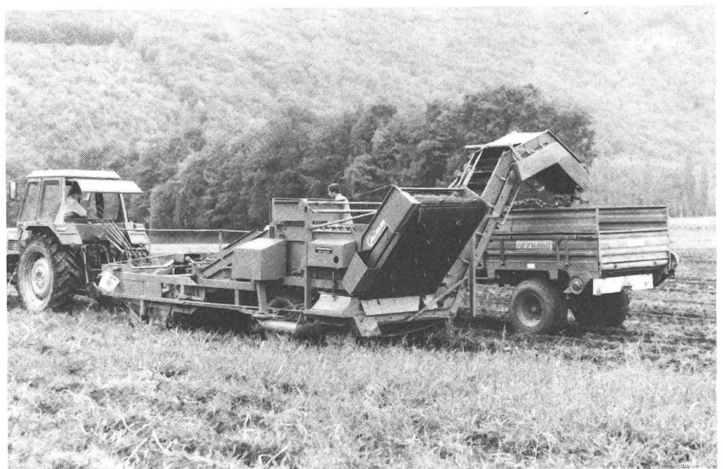
Fig. 3: Arracheuse-ramasseuse simple à deux rangs, avec deux rubans cribleurs, rouleau tire-fanes, élévateur des fanes et ruban de transfert. Etant donné que l'arrachage se fait sans personnel de triage et qu'il n'y a pas de trémie à vider, les performances à la surface peuvent atteindre un niveau élevé.
