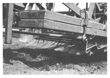
Fig. 9: Pour servir à l'épierrage, l'arracheuseramasseuse est débarassée de ses rouleaux de terrage et des socs plats symétriques sont montés sur toute la largeur du canal de criblage.
