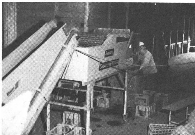
Fig. 5: Machine de séparation électronique stationnaire (Samro). Les impuretés (pierres et mottes) sont écartées avec une grande précision. Les pierres de plus de 800 g environ font exception, de même que les mottes provenant de sols typiquement marécageux.
