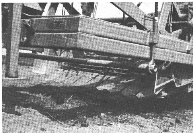
Fig. 9: Pour servir à l'épierrage, l'arracheuse-ramasseuse est débarrassée de ses rouleaux de terrage et des socs plats symétriques sont montés sur toute la largeur du canal de criblage.
