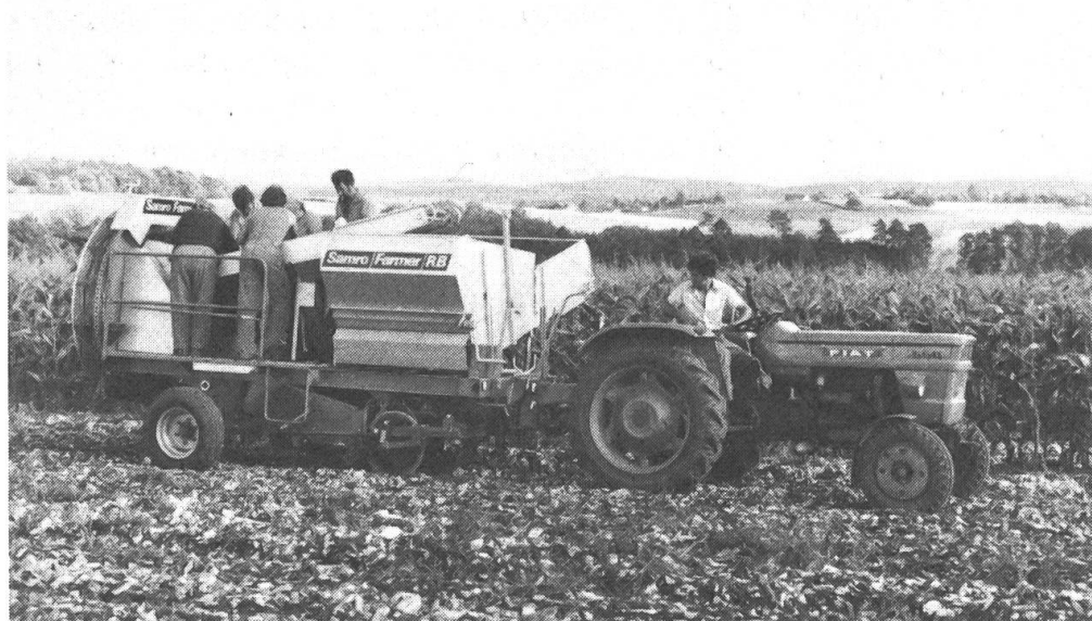
Fig. 1: Dans le procédé avec récolteuse combinée, toutes les impuretés sont séparées sur la machine. Dans la plupart des cas, le travail de triage s'avère un facteur de limitation de la performance.
