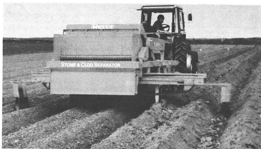
Fig. 6: Machine spéciale pour l'épierrage de billons préformés (Reekie, GB). La dépose des pierres et des mottes séparées intervient entre les rangées. Les pierres de plus grandes dimensions peuvent rester en trémie et être déposées en bordure du champ. Cette machine peut être également équipée d'une planteuse de pommes de terre automatique.
