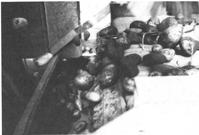
Fig. 2 a) + b): Récolteuse combinée avec dispositif séparateur électronique (b) pour la séparation des pierres et des mottes (Samro). Cette machine a été développée surtout en vue d'économiser la main-d'œuvre et d'augmenter la performance.
