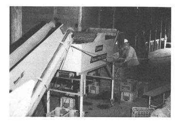
Fig. 5: Machine de séparation électronique stationnaire (Samro). Les impuretés (pierres et mottes) sont écartées avec une grande précision. Les pierres de plus de 800 g environ font exception, de même que les mottes provenant de sols typiquement marécageux.
