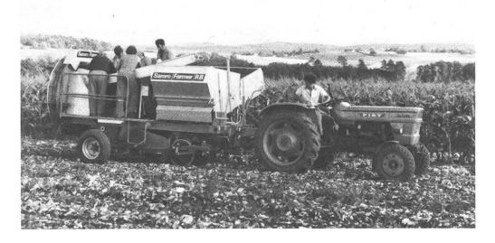
Fig. 1: Dans le procédé avec récolteuse combinée, toutes les impuretés sont séparées sur la machine. Dans la plupart des cas, le travail de triage s'avère un facteur de limitation de la performance.
