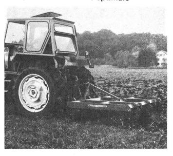
Le chisel MF 24 se prête particulièrement bien à l'ameublissement profond du sol (audessous du fond de sillon) et au déchaumage et peut également remplacer la charrue lors de la préparation de bas du sol. Il est équipé de dents rigides à taillant simple d'une configuration optimale et à angle d'entrure de 25° ainsi que de socs d'une largeur de 8 cm. Sa qualité de travail est remarquable; 1 à 2 passages suffisent pour déchiqueter à fond la surface du champ. Il permet
