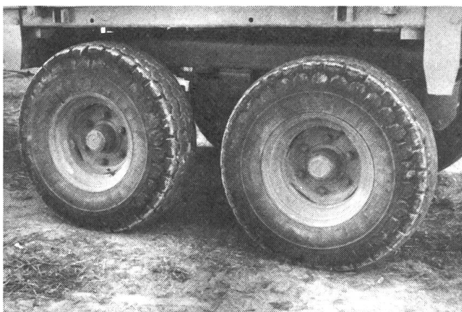
Fig. 5: Si on emploie des modèles pesants ou prépare beaucoup d'ensilage, on ne peut pas se passer d'essieux-tandem.
