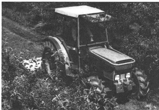
Fig. 6: La cabine de sécurité amplement vitrée de ce tracteur spécial est démontable au moyen de fermetures rapides. Un filtre retenant les substances nocives protège le conducteur très efficacement contre des brouillards de pulvérisation et d'atomisation.
