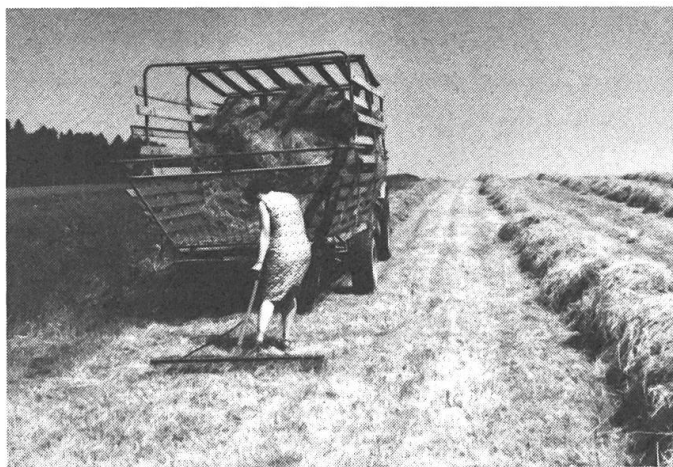
Fig. 1: Certains pick-up ne ramassent pas le fourrage d'une manière satisfaisante.
