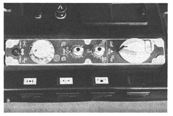
Fig. 7: Les systèmes hydrauliques gouvernés par un dispositif électroniques sont dépourvus des leviers de commande usuels. Des boutons rotatifs ou de pression permettent d'obtenir des réglages d'une précision encore inconnue jusqu'ici.
