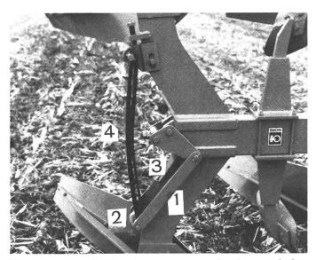
Fig. 1: Lors du décliquetage du corps de charrue, le levier à genoulière (1) transmet la course de levage au petit rouleau (2) guidé par la coulisse incurvée (3). Le ressort à lames précontraint (4) produit la contrepression agissant sur le rouleau de la genoulière.
