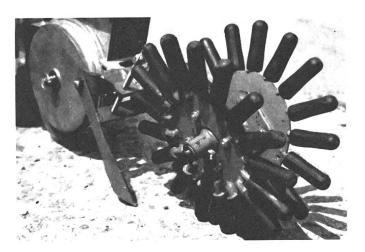
Fig. 2: Dispositif compresseur à doigts de caoutchouc monté sur un semoir monograine.
