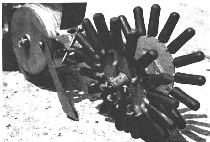
Fig. 2: Dispositif compresseur à doigts de caoutchouc monté sur un semoir monograine.
