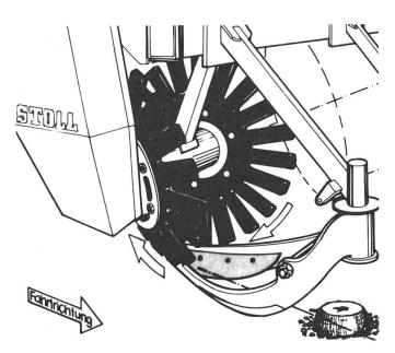
Fig. 3: Le système d'arrachage à roues élevatrices comporte deux disques garnis de doigts en caoutchouc placés au-dessus des socs.
