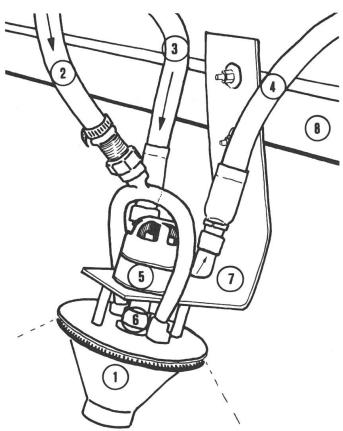
Fig. 4: Schéma d'une buse rotative: (1) Disque rotatif à pourtour dentelé, (2) conduite d'amenée du pesticide, (3) et (4) conduites hydrauliques pour l'entraînement du disque rotatif, (5) moteur hydraulique, (6) axe raccordant le moteur hydraulique au disque rotatif, (7) porte-buses, (8) rampe.
