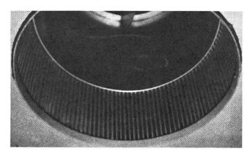
Fig. 4: Echangeur de chaleur à soufflet à plis (vu du côte de l'orifice d'où émerge l'air sortant).
