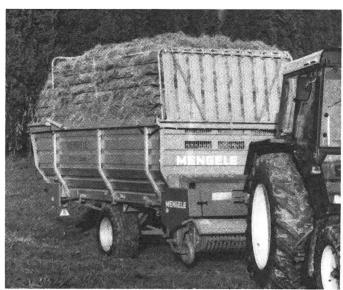
Un Mengele LW 310 S Quadro d'une capacité de 27 m<sup>3</sup> et à timon pivotant hydraulique (photo fournie par l'usine).
