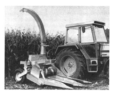
Récolteuse-hacheuse Mengele SH 20 à disque hacheur de grand rendement porté ou latéralement ou à l'arrière et équipée d'un bec cueilleur pour 2 rangs de maïs ou d'un pick-up.
