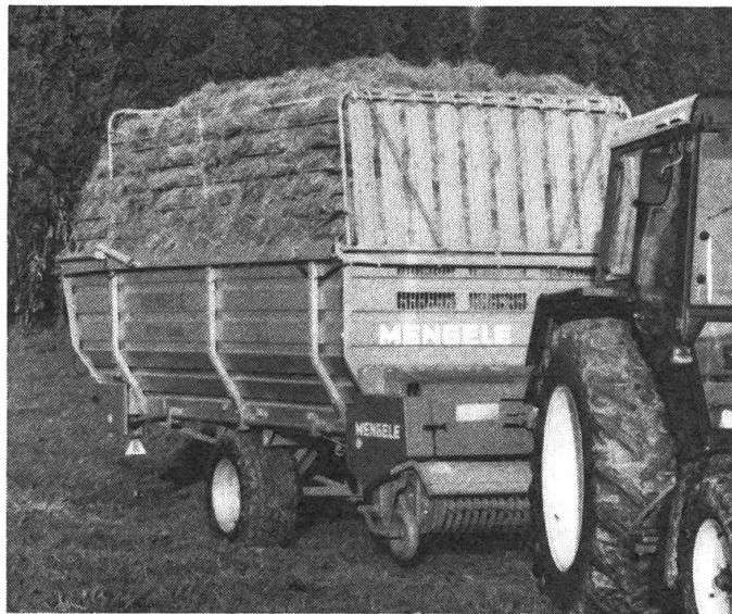
Un Mengele LW 310 S Quadro d'une capacité de 27 m 3 et à timon pivotant hydraulique (photo fournie par l'usine).
