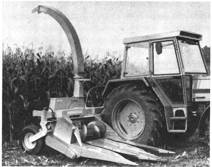
Récolteuse-hacheuse Mengele SH 20 à disque hacheur de grand rendement porté ou latéralement ou à l'arrière et équipée d'un bec cueilleur pour 2 rangs de maïs ou d'un pick-up. Rohrer-Marti, Regensdorf ZH
