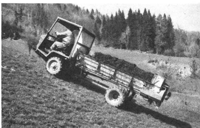
Fig. 6: Il va de soi que le transporteur Universal prévu pour des exploitations herbagères sur terrains déclives doit être équipé d'un système de traction sur les quatre roues.
