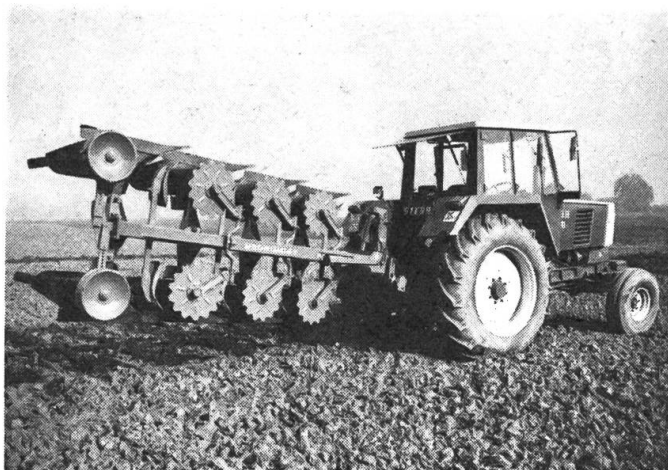
Fig. 1: Une conception surannée: un tracteur de 88 kW sans propulsion avant additionnelle.
