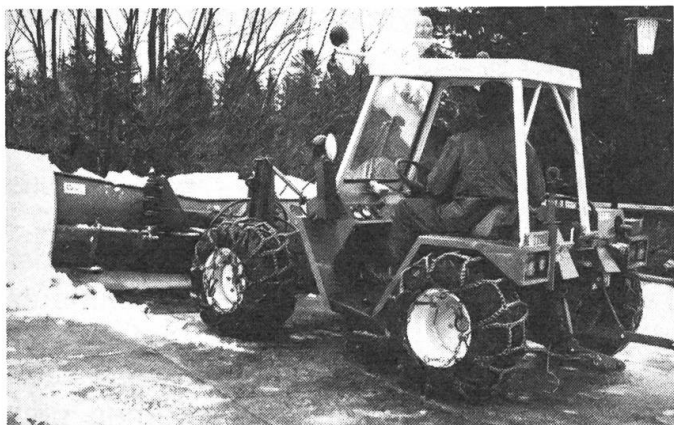
Fig. 4: Un déblaiement rationnel de la neige exige absolument une propulsion sur les quatre roues.
