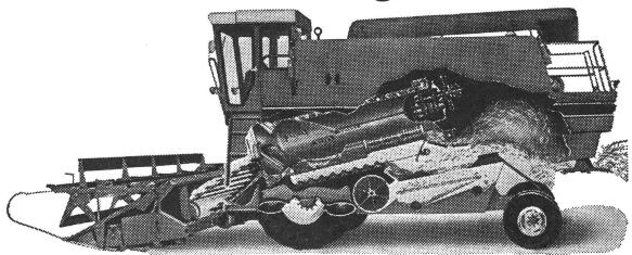
Axial-flow – un système de moissonneuse-batteuse totalement nouveau.
