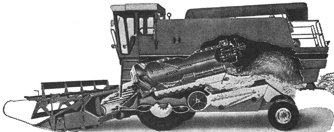
**Axial-flow – un système de moissonneuse-batteuse
