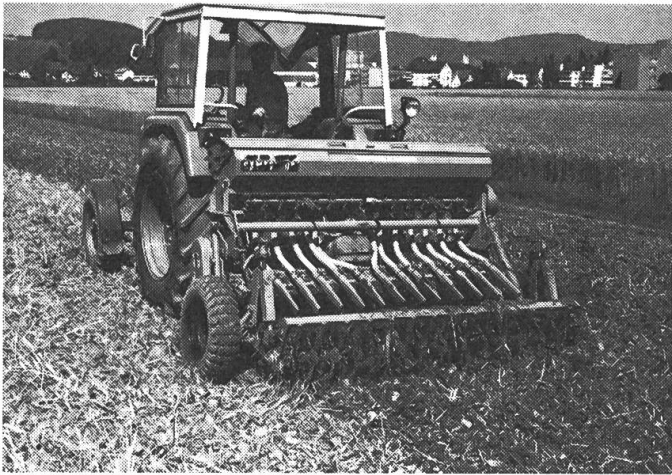
Fig. 4: Préparation du sol avec la fraise; le rouleau-émotteur à l'arrière termine le travail de préparation du sol et contribue aux bonnes conditions de croissance des plants.
