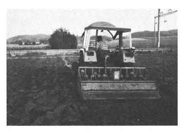
Fig. 1: Après le passage de la machine à bêches pendulaires, la structure du sol se présente sous forme de mottes moyennes et sans tassements; à gauche de l'image, labour traditionnel.
