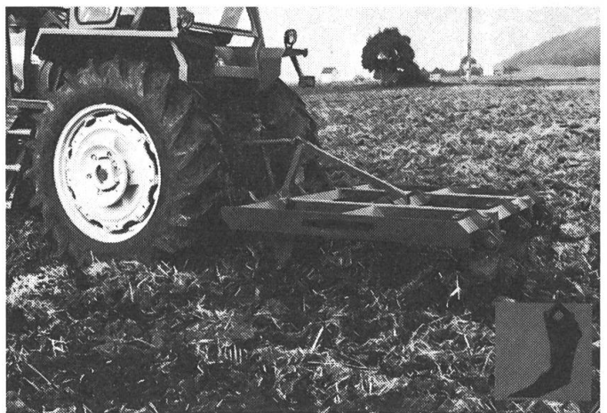
Fig. 2: Parmi les modèles de cultivateurs lourds, ce sont ceux qui présentent des dents rigides qui se prêtent particulièrement bien pour la préparation du sol sans charrue.
