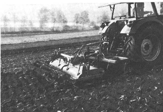
Fig. 3: Si le cultivateur lourd est muni d'un outil complémentaire (fraise agricole), le sol peut être éventuellement travaillé en un seul passage. Mais cette combinaison de machines exige des tracteurs de plus de 50 kW (80 ch).
