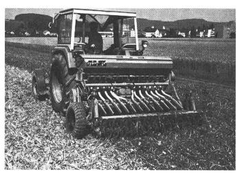
Fig. 4: Préparation du sol avec la fraise; le rouleauémotteur à l'arrière termine le travail de préparation du sol et contribue aux bonnes conditions de croissance des plants.
