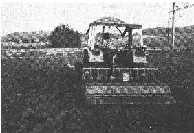
Fig. 1: Après le passage de la machine à bêches pendulaires, la structure du sol se présente sous forme de mottes moyennes et sans tassements; à gauche de l'image, labour traditionnel.
