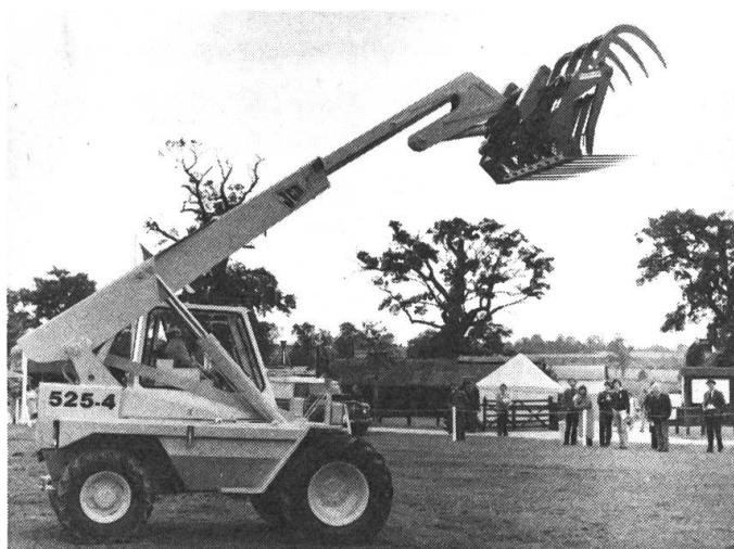
Ce véhicule a une capacité de charge maximale de 2,5 tonnes, une hauteur de levage de 6,4 m et une portée de 3,62 m; il a été réalisé pour les exploitations agricoles où ses quatre roues motrices conviennent parfaitement aux terrains difficiles.
