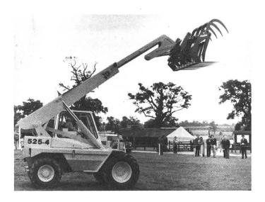
Ce véhicule a une capacité de charge maximale de 2,5 tonnes, une hauteur de levage de 6,4 m et une portée de 3,62 m; il a été réalisé pour les exploitations agricoles où ses quatre roues motrices conviennent parfaitement aux terrains difficiles.
