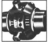
de blocage au différentiel; déverrouillage automatique dans les courbes. D'où rendement encore accru de traction sur 4 roues. **OPTITRAC** est libre d'usure et d'entretien.
