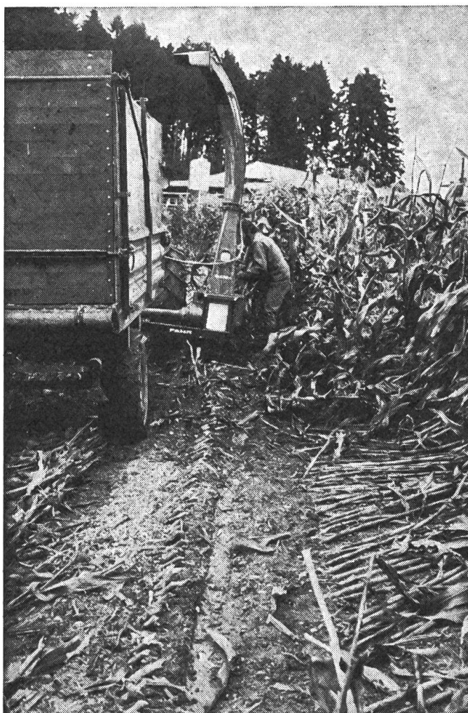
Fig. 3: Surtout dans le maïs versé, un dispositif d'inversion du sens de rotation est apprécié lorsqu'il s'agit de débourrer.
