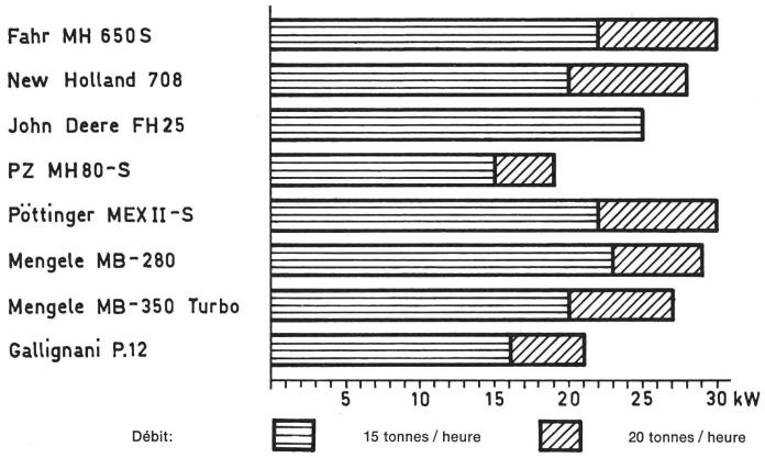
Fig. 2: Besoin en puissance au niveau de la prise de force.
