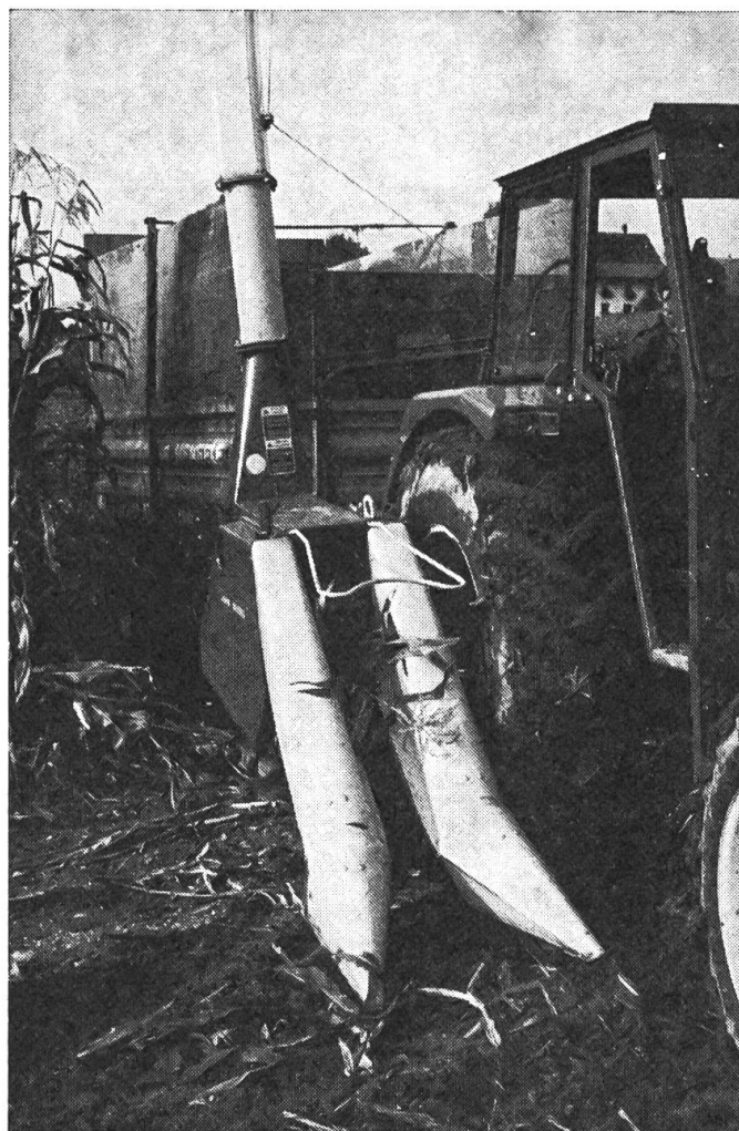
Fig. 4: Une bonne visibilité sur les pointes du bec cueilleur est souhaitable partout, non seulement dans le maïs versé.
