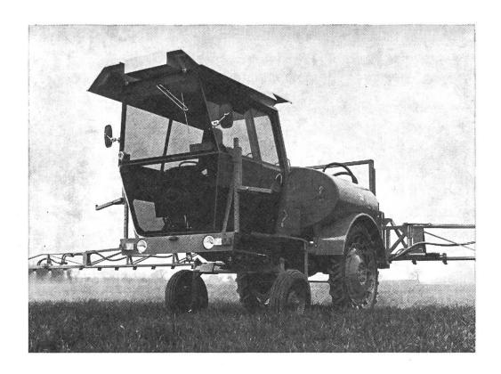
triques, qui seraient susceptibles d'être attaqués par les produits chimiques. Une soupape de sécurité arrête la pulvérisation en cas de défaut de fonctionnement. Ces véhicules peuvent être livrés facultativement avec des systèmes de climatisation et d'adaptation pour la pulvérisation de microgranulés.
