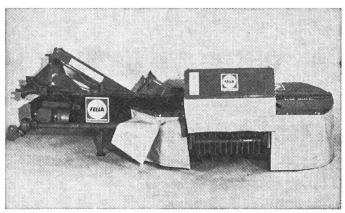
Les nouvelles faucheuses-conditionneuses FELLA sont livrables dans les largeurs de travail de 1,65, 1,90 et 2,10 m.
