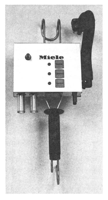
Un processeur minuscle développé par la firme Miele a pu être incorporé avec un voyant et un pulsateur — tous deux résistants aux chocs et étanches aux projections d'eau — dans la solide construction en métal antirouille d'une machine à traire commode et compacte.
