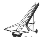
Tapis roulant à ruban de caoutchouc ruban plat, à bande en auge ou à arète ondulée
