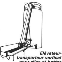
pour silos et bottes pour silos allant jusqu'à 10,3 m
