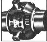
OPTITRAC donne 100% de blocage au différentiel; déverrouillage automatique dans les courbes. D'où rendement encore accru de traction sur 4 roues. OPTITRAC est libre d'usure et d'entretien.
