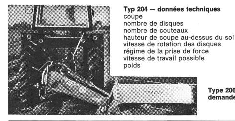
1,61 m 4 8 30-60 mm 3000 t/min 540 t/min entre 6 et 25 km/h 285 kg
