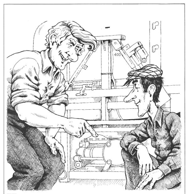
Venons en à la pompe: Les pompes à pistons Birchmeier sont renommées pour leur constance de débit quelle que soit la pression de travail. La nouvelle Meteor par exemple, avec un débit de 160 lt. et une pression de 30 bar nous permet l'utilisation de barres jusqu'à 15 m de largeur.
